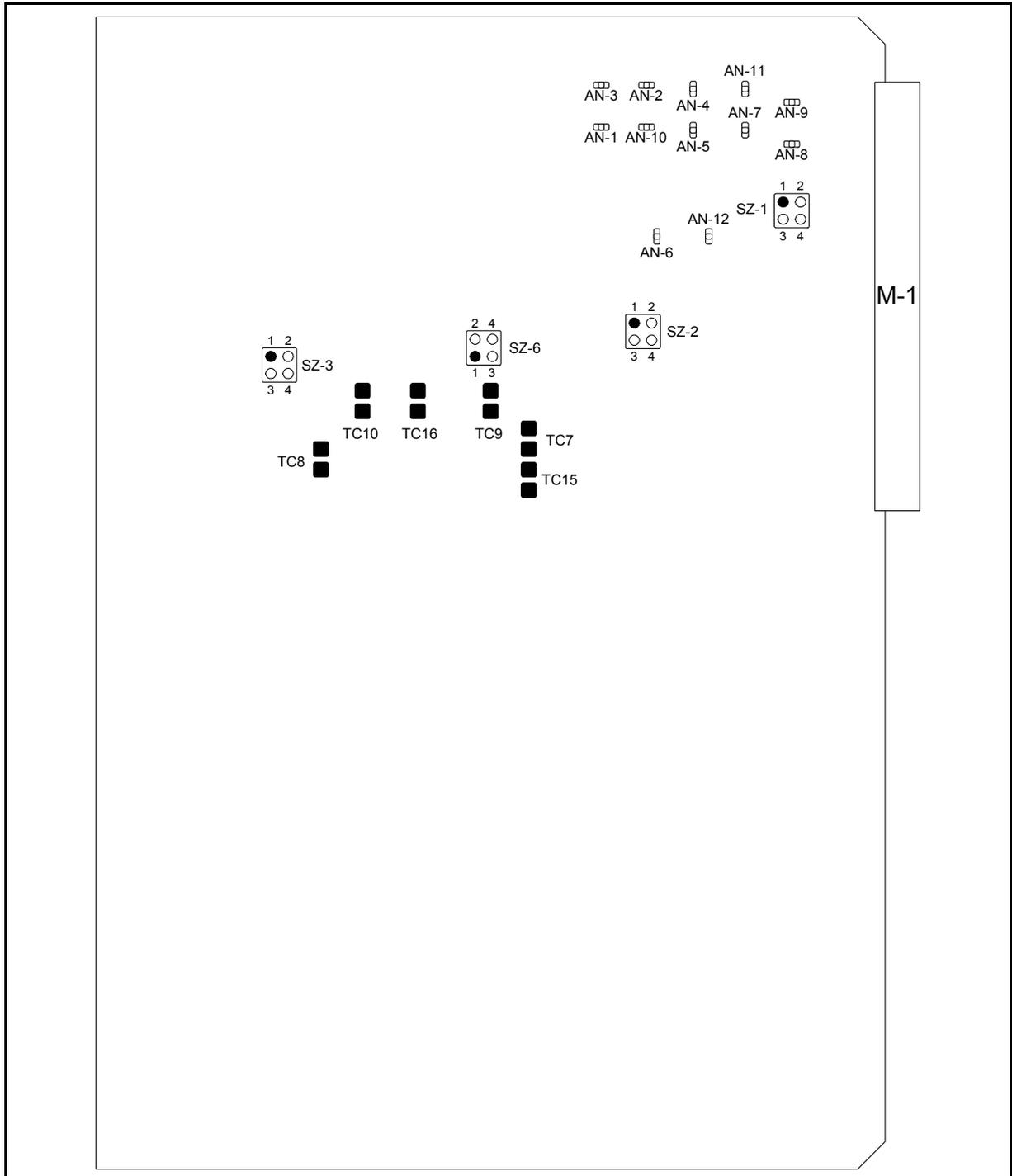
FIGURE 22 – INRX JUMPERS TO HF LINK CONNECTION
