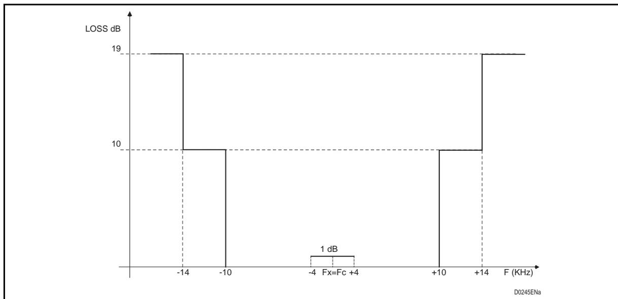
FIGURE 25 – FREQUENCY / LOSS MASK DOUBLE CHANNEL
