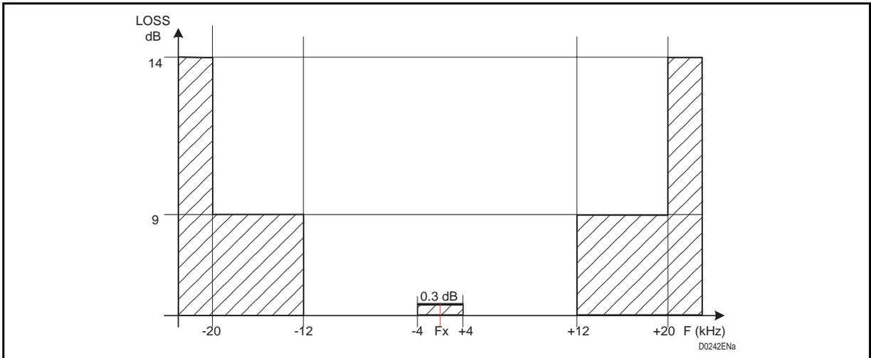
FIGURE 20 – FREQUENCY / LOSS MASK FOR  $FC \leq 392$  KHZ
