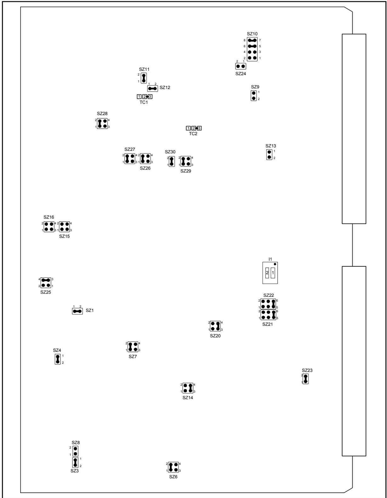
FIGURE 7 – LFS 411.410.035 FACTORY JUMPERS LAY-OUT
