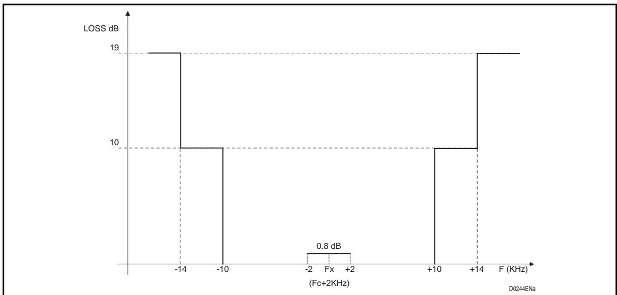
FIGURE 24 – FREQUENCY / LOSS MASK SINGLE CHANNEL
