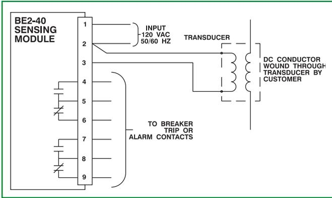
FIGURE 2. TYPICAL INTERCONNECTION DIAGRAM
